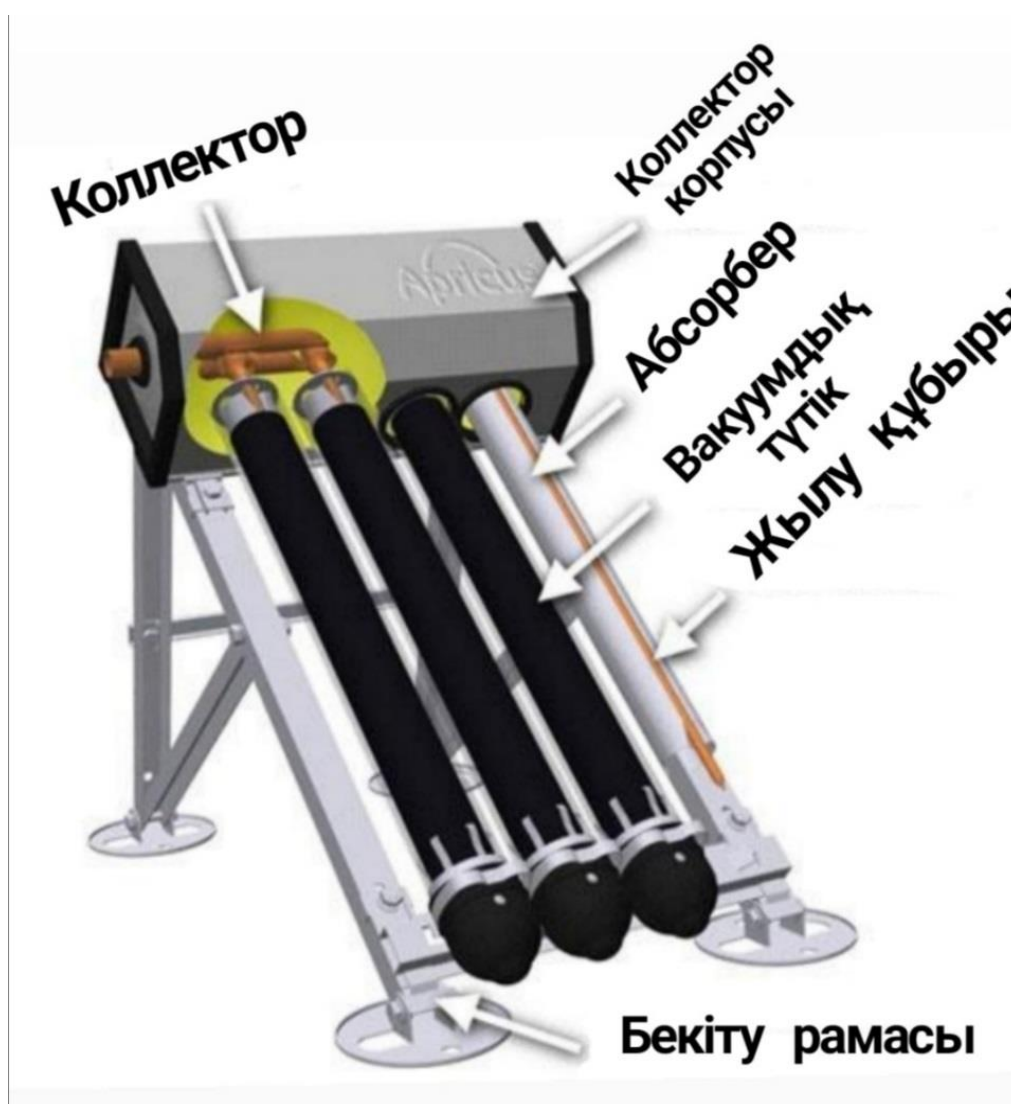
1.3- сурет - Қимадағы вакуумдық күн коллекторы. Құрамы және құрылымдық элементтері
