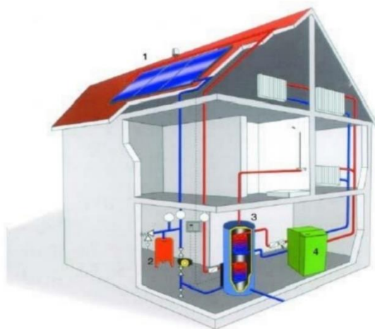
1 - күн коллекторы; 2- кеңейткіш бак; 3 - бак аккумулятор; 4 – жылыту қазандығы
